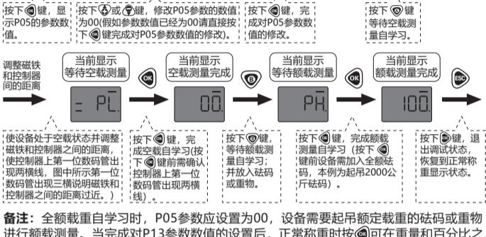
备注：全额载重自学习时, P05参数应设置为00, 设备需要起吊额定载重的砝码或重物进行额载测量。当完成对P13参数数值的设置后, 正常称重时按OK可在重量和百分比之间切换显示。
