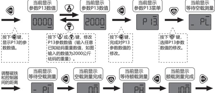
备注：全额载重自学习时, P05参数应设置为00, 设备需要起吊额定载重的砝码或重物进行额载测量。当完成对P13参数数值的设置后, 正常称重时按OK可在重量和百分比之间切换显示。
